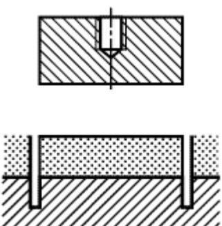
Рисунок 9 - Разрушение по слою клея (испытание следует повторить)
