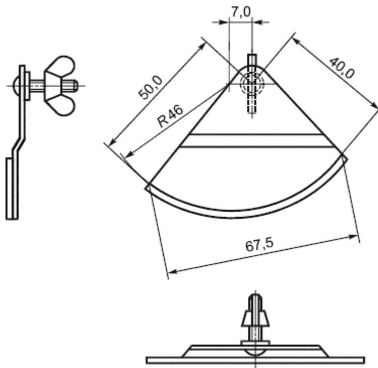
Рисунок 2 - Пластика-фиксатор подвижного стержня с конусом
